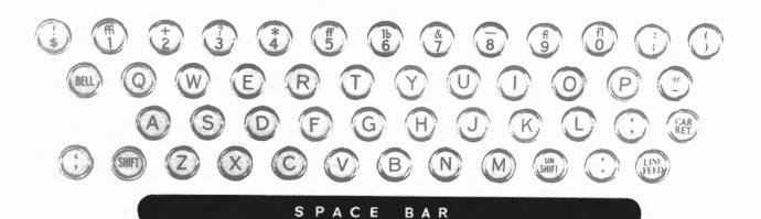
TYPICAL KEYTOP ARRANGEMENT — TELETYPE MODEL 20 PRINTER
