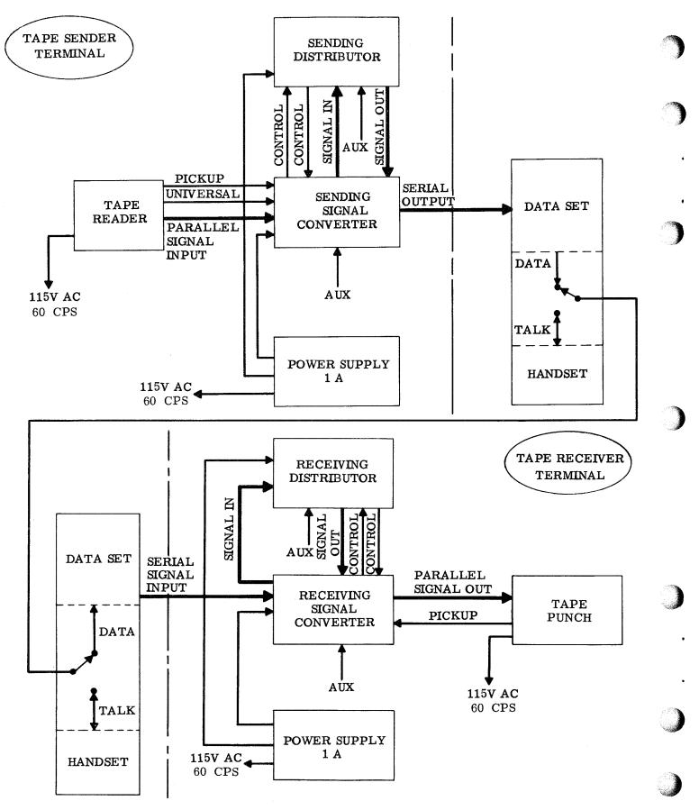
Figure 1-System Block Diagram
